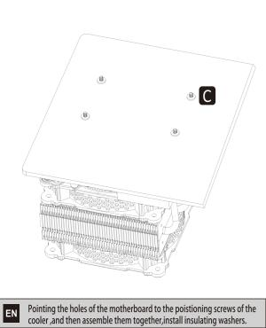
将主板孔位对准散热器定位螺丝,反扣于散热组上,装入 绝缘垫片。
