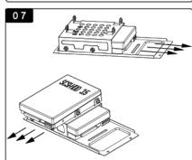
安装硬盘,箭头方向为硬盘数 据接口方向。按顺序装入硬盘, 硬盘盒内部为第一硬盘位,硬 盘盒底部为第三硬盘位。
