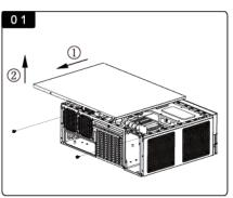
松开后板两颗螺丝, 向后拉出 顶盖, 向上取出。
