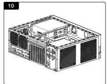
装回中支撑架,放回光驱架, 连接好数据线。
