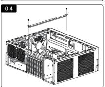
松开两颗螺丝,向上取出中支撑架。
