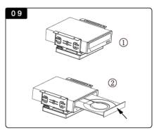
装入光驱,注意螺丝固定孔 位的选择,如图②示,如果 光驱的托盘仓门过大,需要 拆下托盘仓门。
