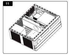
装入显卡,连接数据线。 Install display card and connect any display card cable if available.
