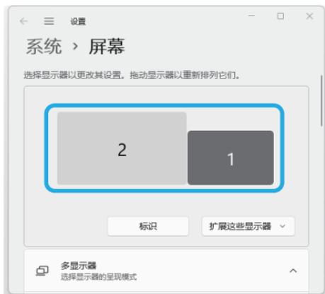
4. 檢查其餘設置項：多顯示器模式選擇“擴展這些顯示器”，並將主屏“設為主顯示器”。
